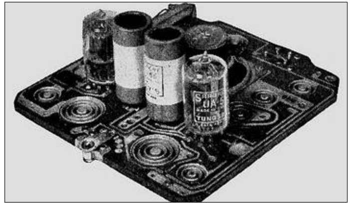
Bild 14 (rechts oben). ZF-Verstärker-Schaltung nach F. M. COLEBROOK, die nicht neutralisiert werden muss.
