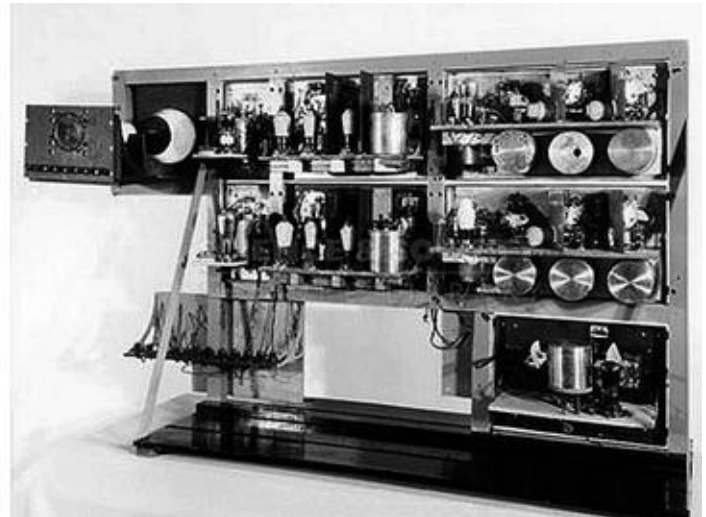
Bild 4. links: Watson-Watt-Gerät zur Untersuchung der Ionosphäre (etwa 1924), rechts: Die Originalausstattung von WATSON-WATT und WILKENS, die 1935 verwendet wurde, um das Radar-Prinzip zu demonstrieren.
