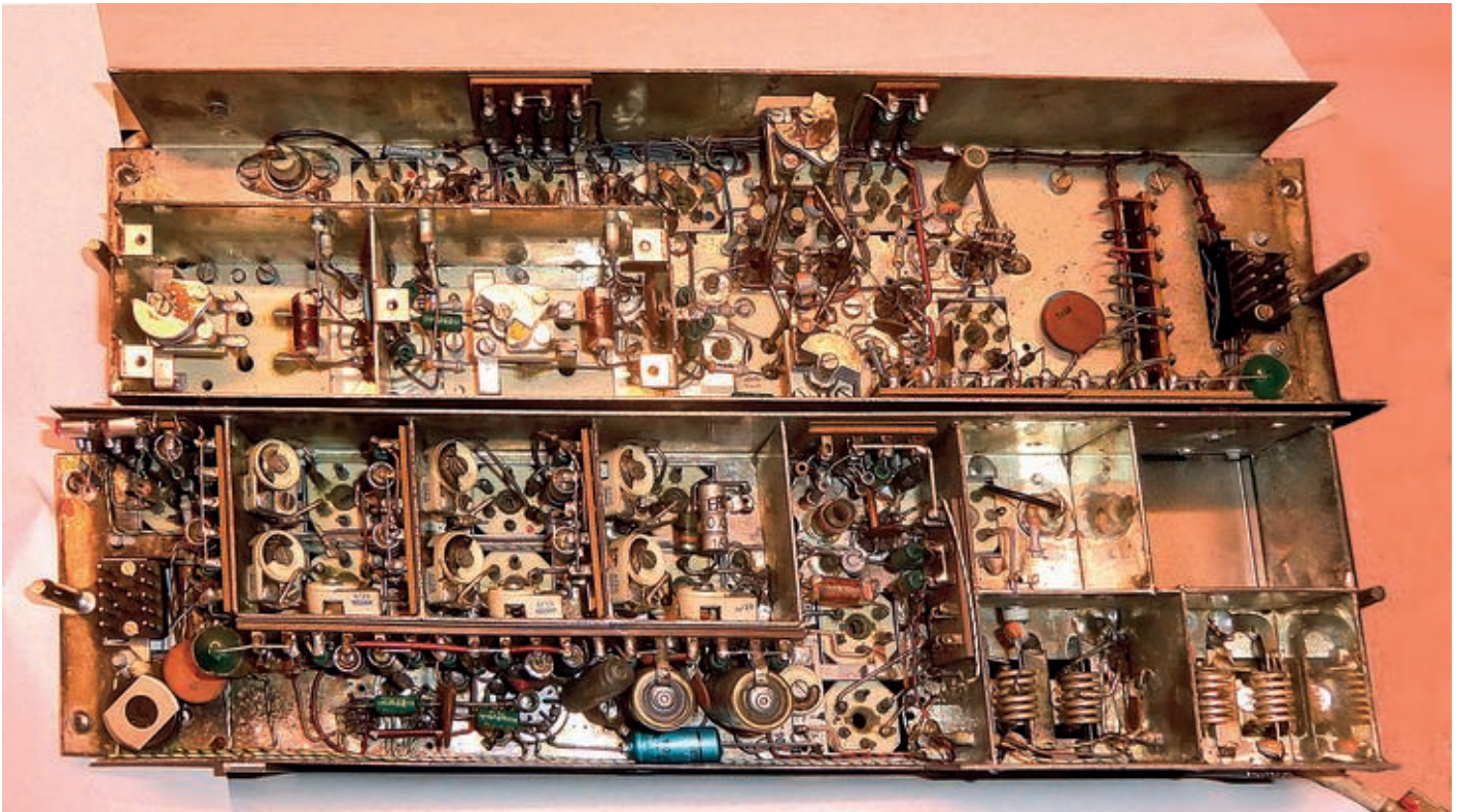
Bild 7. Chassis des Senders (oben) und des Empfängers (unten) von unten. Die Abdeckbleche unter Rö 8 und 9 des Senders und die versilberten Bleche unter den Spulen der Empfänger-Eingangsstufen wurden entfernt, um die Schaltelemente sichtbar zu machen.
