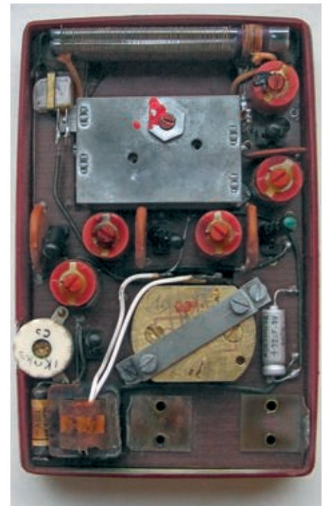
Bild 5. Telefunken-Prototyp vom März 1955, Bestückungsseite, Handverdrahtung.
