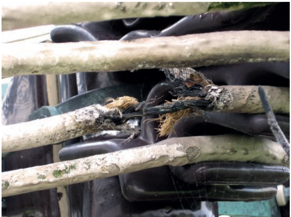
Bild 4. Beschädigte Spule von 1924. Bild: O. Kjellgren
