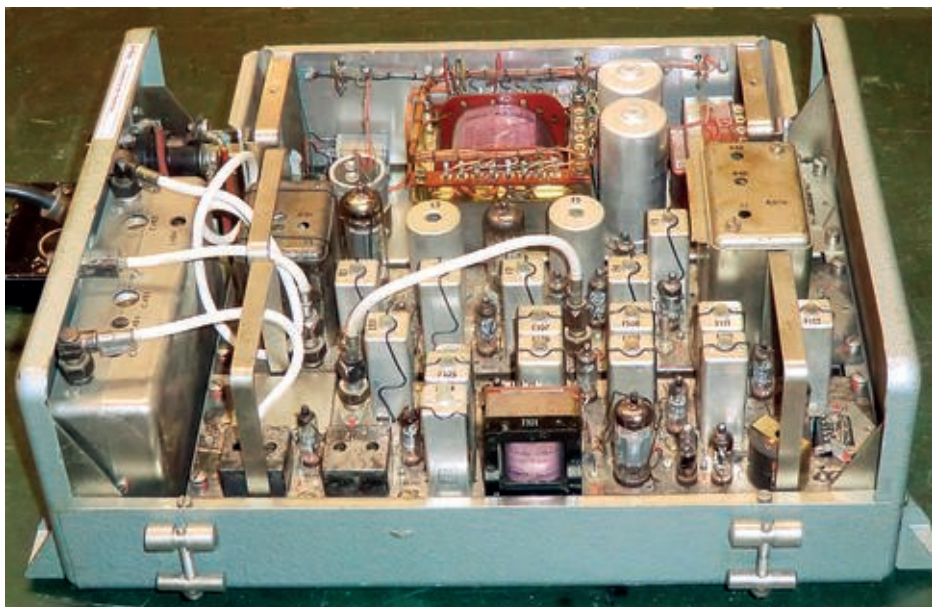
Bild 3. Sendeempfänger mit abgenommenen Abdeckblechen. Frontplatte (links): Anschlusskabel von Empfänger an Antennenweiche, darüber Anschluss vom Bediengerät an Sendereingang, darüber Anschluss Senderausgang an Frequenzweiche. Vorn das Chassis des Empfängers, dahinter das des Senders mit der Abschirmung des Ausgangskreises (links) und Mikrofonverstärker-Kästchen (rechts mit RÖ10), dahinter das Chassis des Netzteils mit abgenommenem Abschirmblech.
