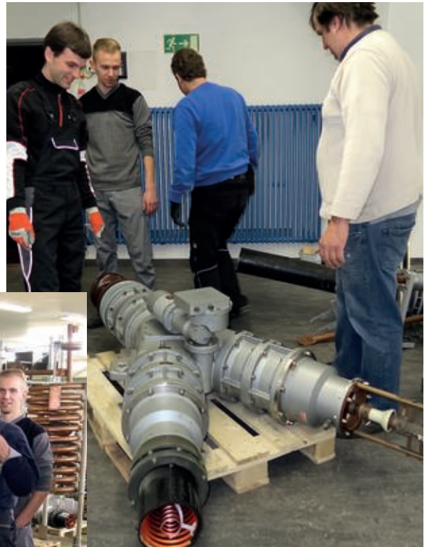
Verdammt schwer das Ding! Der Hosen-schalter kann 600 kW schalten.
