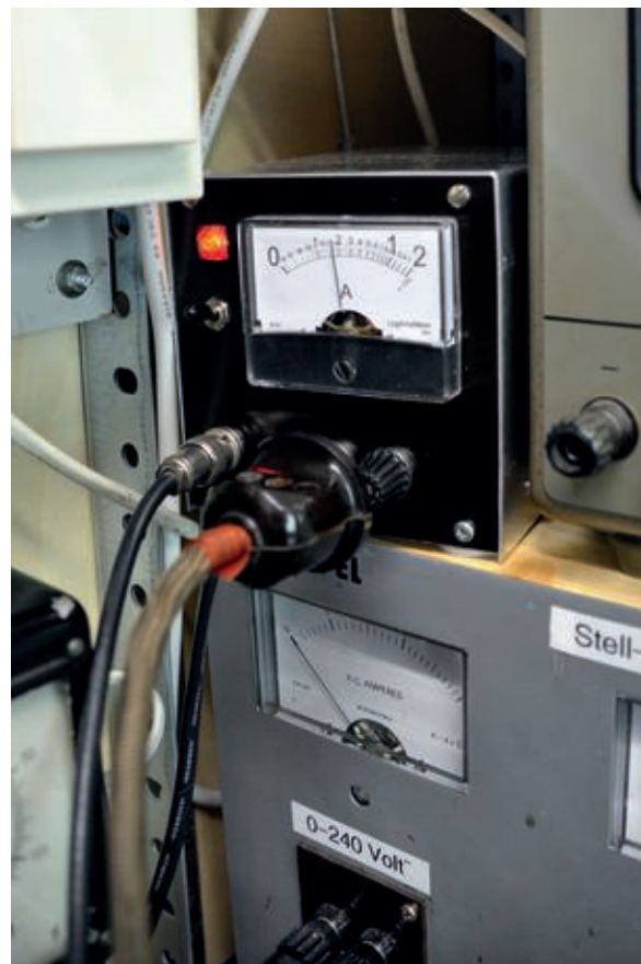
Bild 4. Im praktischen Betrieb: Während der Zeiger des Dreheiseninstrumentes des Stell-Trenntrafos sich kaum vom Nullpunkt abhebt (unten) zeigt das logarithmische Amperemeter (oben) die Stromaufnahme des angeschlossenen Allstrom-Radios (etwa 180 mA) gut ablesbar an.
