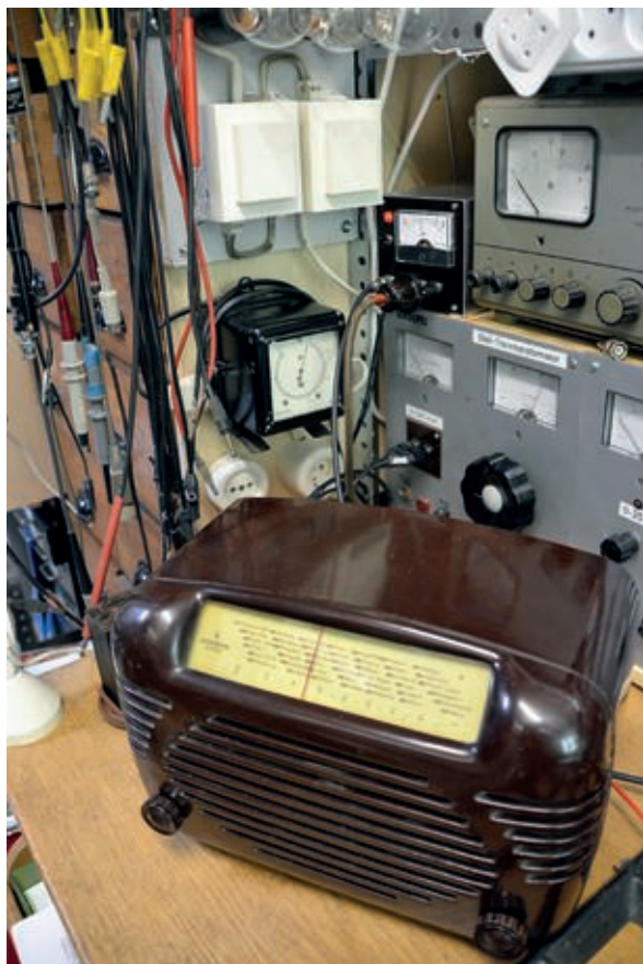
Bild 3. Das separate Messgerät kann in Zusammenhang mit dem Stell-Trenntrafo, den Vorschalt-Glühbirnen (über dem Wattmeter) oder dem 117-V-Trafo für US-Geräte benutzt werden.
