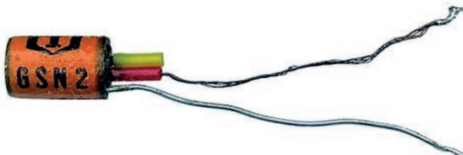
Bild 23. GSN2. Man beachte die beim GSN1-Beispiel (Bild 22) fehlende Farbcodierung (Collector gelb und Emitter rot). Bild: A. Wylie.
