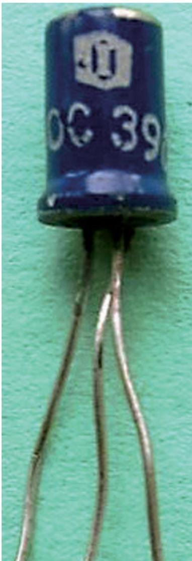
Bild 28. Intermetall-Transistor OC390. (Bild: J. Röhling, Radiomuseum)
