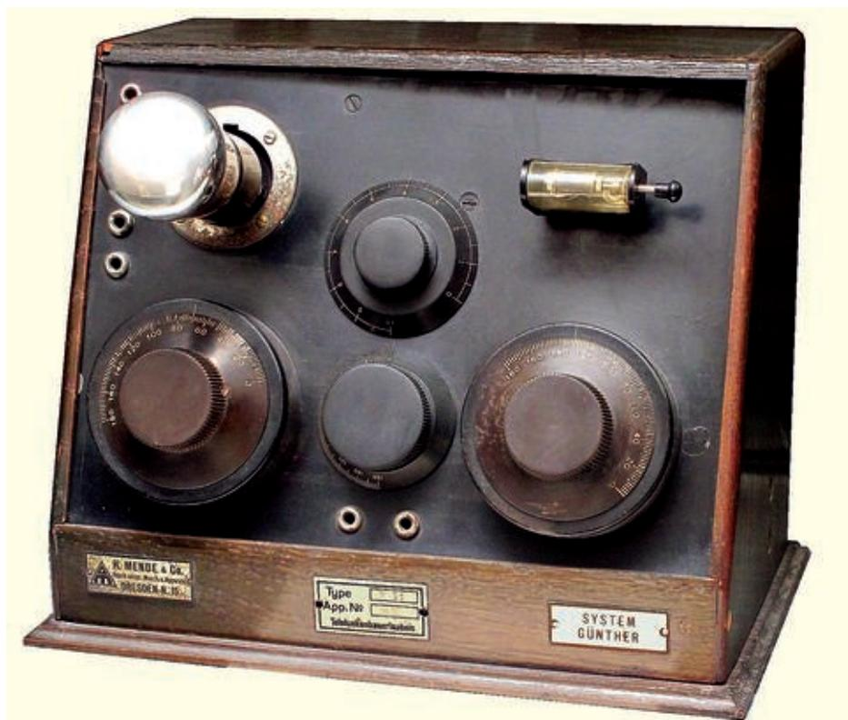
Bild 6. Einröhren-Zweikreis-Reflex-Empfänger Typ „E 31“ von 1925, Fabrikationsnummer 2533.
