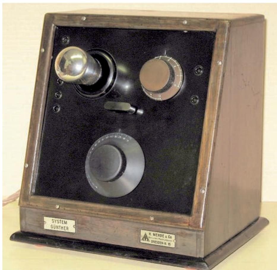
Kurzschlussbügel sowohl in der Langwellen-, als auch in der Mittelwellenstellung der Detektorkristall an einer Anzapfung der Schwingkreis-Spule liegt (Kurzschließer 2, rechter Bügel).
