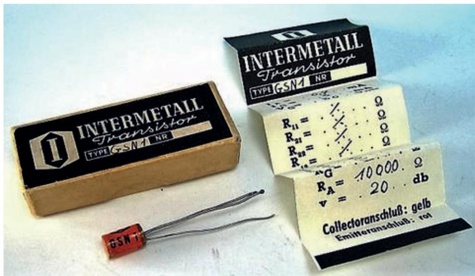
Bild 22. Heute noch existierende Beispiele des GSN1 oder GSN2. Eine Ausführung der zweiten Generation mit den drei Anschlussdrähten an einem Ende.
