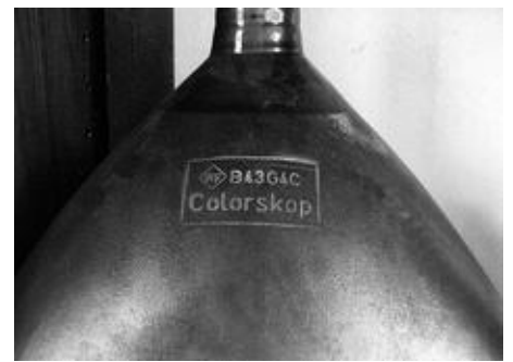
Bild 28. Farbbildröhre „Colorskop“ B43G4C, Entwicklungsmuster von 1960.
