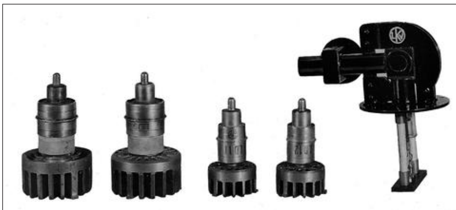
Bild 13. Höchstfrequenz-Metallkeramik-Röhren LD6...LD12 sowie rechts ein Magneton.
