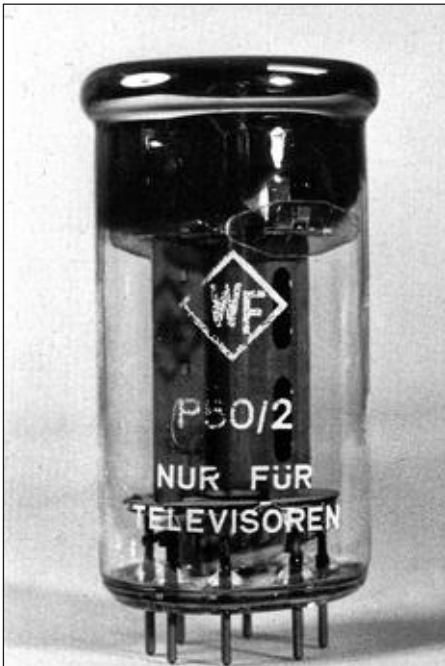
Bild 18. Zeilenendröhre für das sowjetische TV-Gerät „T-2 Leningrad“: Die Spezialversion der Senderöhre LS50 war mit dem Aufdruck „Nur für Televisoren“ gekennzeichnet.
