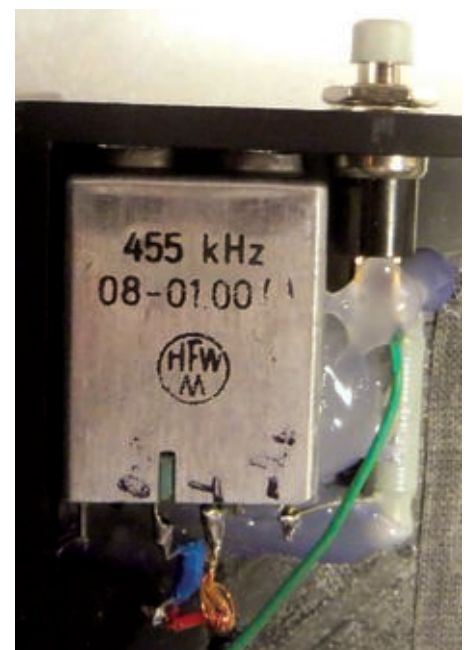
Bild 9. Der BFO ist in ein Bandfiltergehäuse eingebaut und kann von außen abgeglückt werden.
