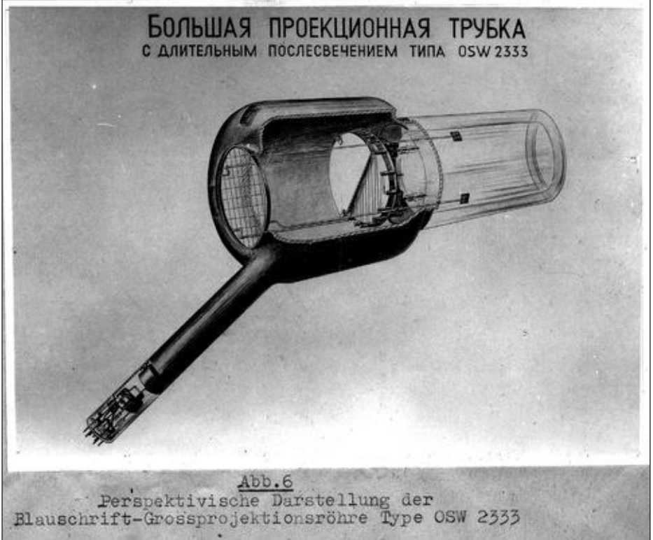
Bild 16. Blauschrift-Grossprojektionsröhre OSW2333, mit der Radarbilder mit einer Breite von 1,20 m projiziert wurden.
