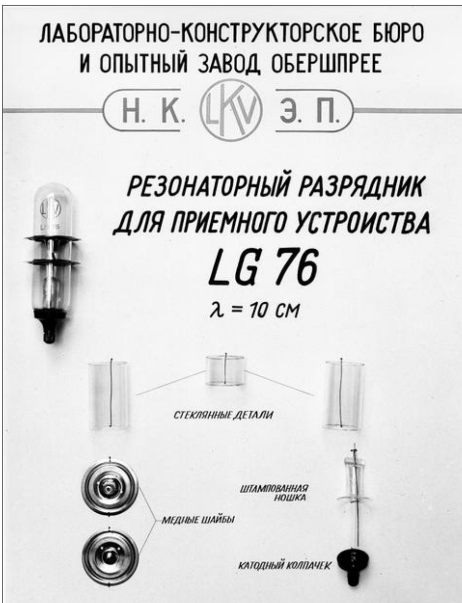
Bild 12. Russische Beschreibung der Sperröhre LG76.
