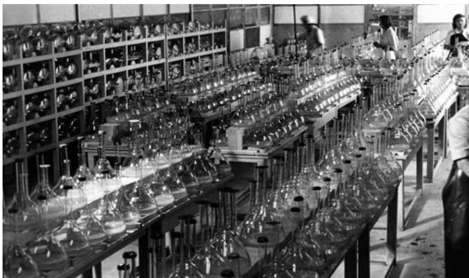
Bild 20. Im „Settelraum“ setzt sich die Leuchtschicht auf der Innenseite der Kolben ab.
