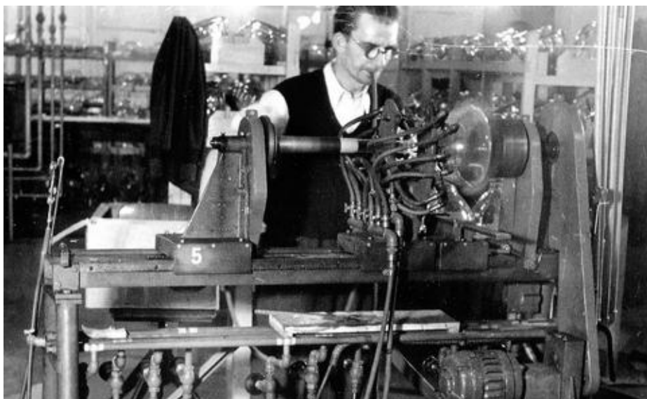
Bild 19. Anschmelzen des Röhrenhalses an das Kolbengefäß der Bildröhre LK-23 1b.
