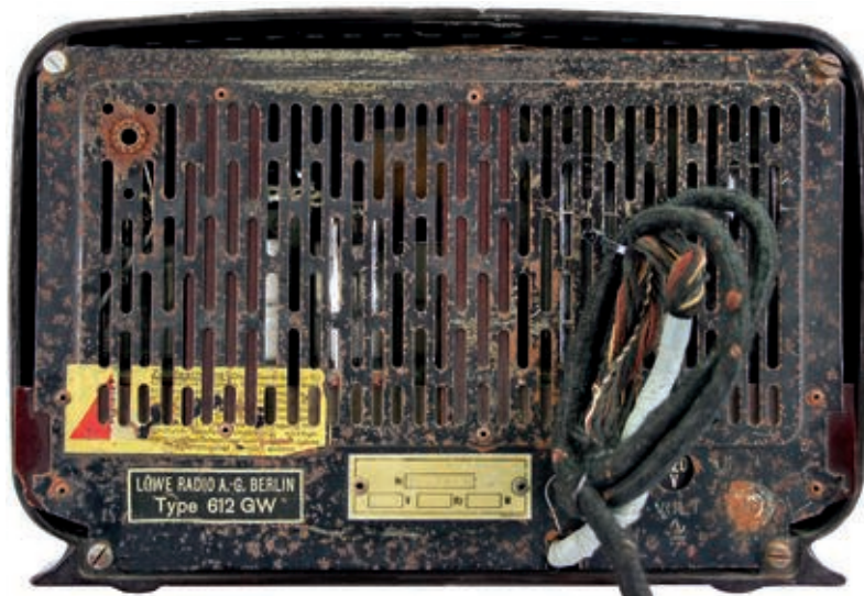
Bild 10. Rückwand des Löwe Radio 612GW, basierend auf dem Philips 204U. Sammlung: J. Gerbig
