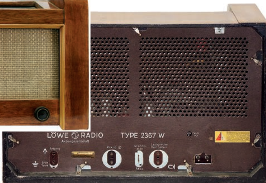
Bild 24. Rückwand Löwe Radio 2367W (=789A). Durch eine Öffnung in der Rückwand ist das goldfarbige Philips-Typschild sichtbar. Sammlung: J. Gerbig, Bild: Bernhard Nagel
