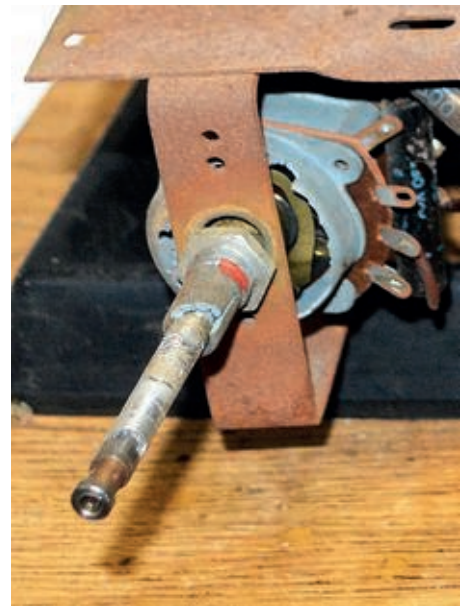
Bild 4. Das Kombipotenziometer ist wegen „Zinkpest“-Befall zerbröckelt, die Befestigungsmutter lässt sich nicht mehr bewegen.
