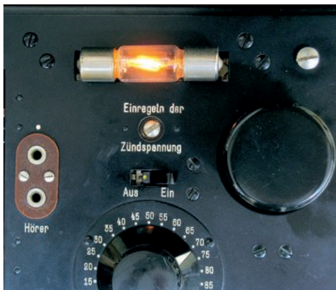
Bild 4. Zündung der Glimmlampe als Eichkontrolle.
