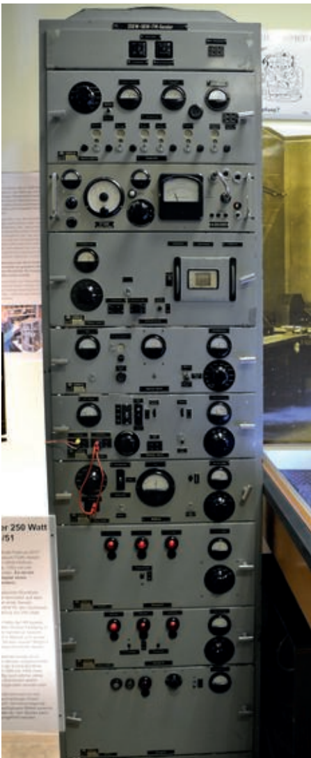
Bild 3. 250-W-UKW-Sender von 1950. Es handelt sich um den ersten UKW-Sender des Hessischen Rundfunks, der auf dem Großen Feldberg im Taunus seinen Dienst verrichtete. Der Lorenz-Sender wurde in Cham restauriert und ist jetzt wieder betriebsbereit.
