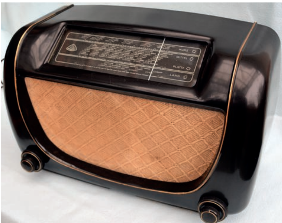
Bild 13. Das Gerät sieht doch gut aus nach der Behandlung mit Autopolitur und Schuhcreme!
