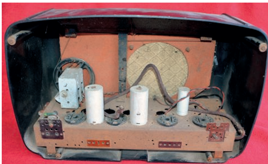
Bild 2. Blick nach Innen: Lautsprecher und Röhren fehlen, das Chassis ist verrostet und verdrückt.
