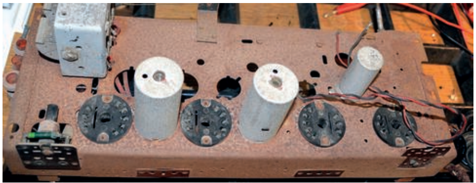
Bild 3. Das Chassis mit dicker Rostschicht.
