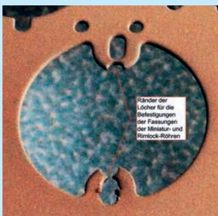
Bild 15. Die merkwürdigen Einkerbungen an den Löchern für die Stahlröhrenfassungen.
