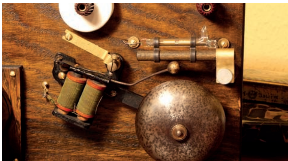
Bild 7. Detailansicht Glocke und Kohärer.
