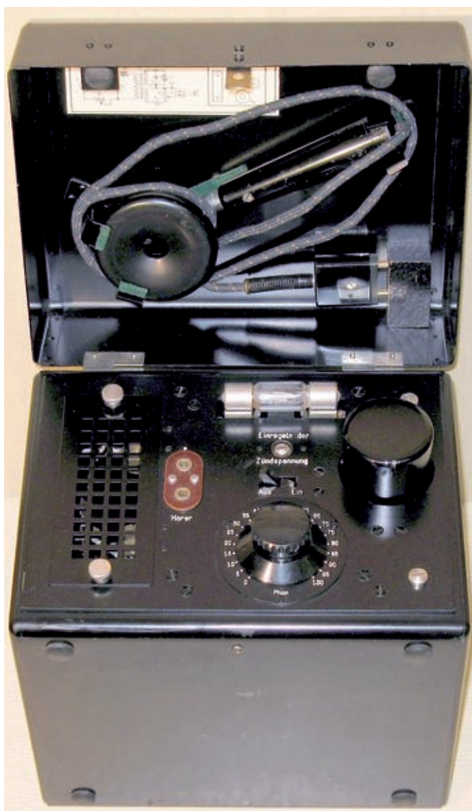
Bild 3. Neue Version ab 1936. Der Messbereich erstreckt sich in 5er-Stufen von 0 bis 100 Phon.
