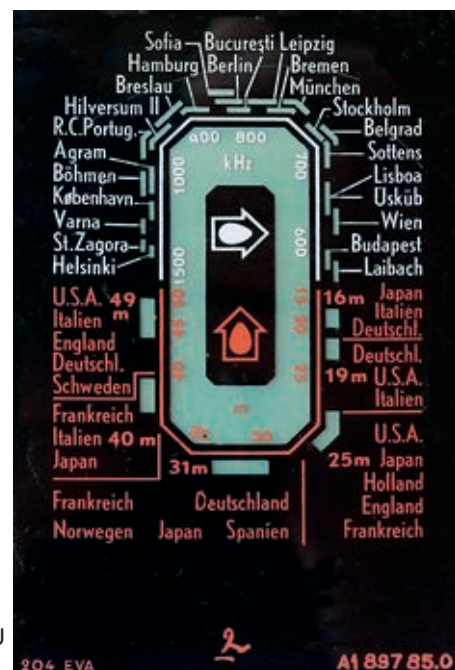
Bild 8. Von Philips gefertigte Skala für Verlagerungsgeräte, die auf dem Philips 204U basieren, mit Skala-Codenummer „A1 897 85.0“.
