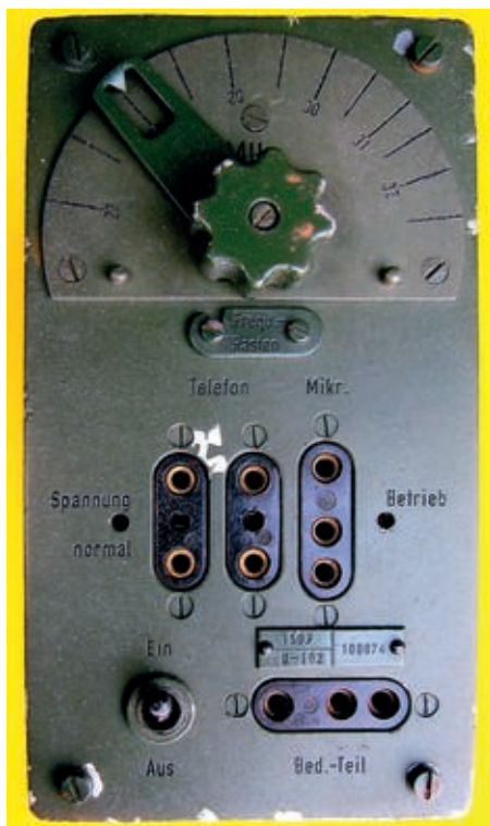
Bild 5. Vorderansicht: oben Frequenzeinstellung 27 – 32 MHz, Mitte Anschlüsse für Hörer und Mikrophon, unten Ein-/Aus-schalter, Buchse für Bedienteil.
