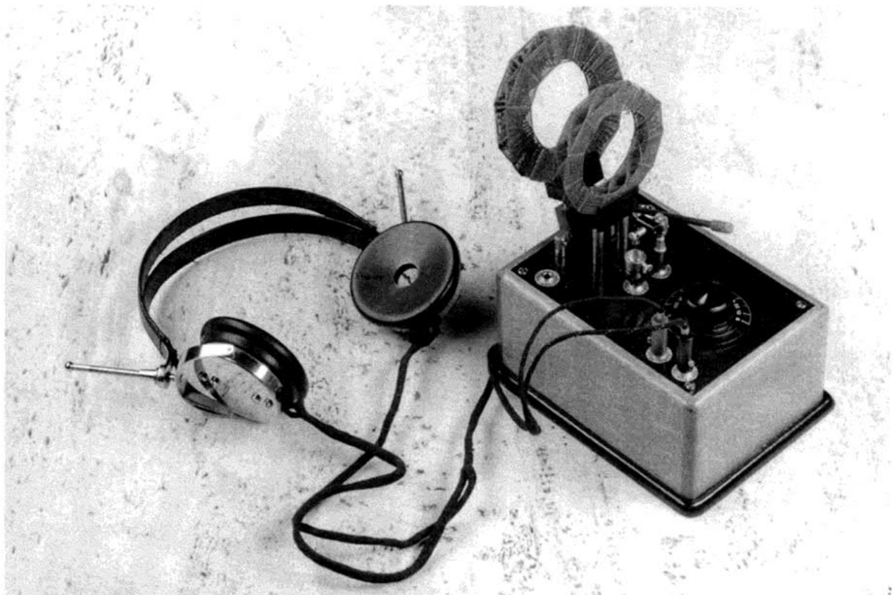
Bild 3: Erhöhte Trennschärfe durch einstellbare Kopplung (Modell DA 0191)
