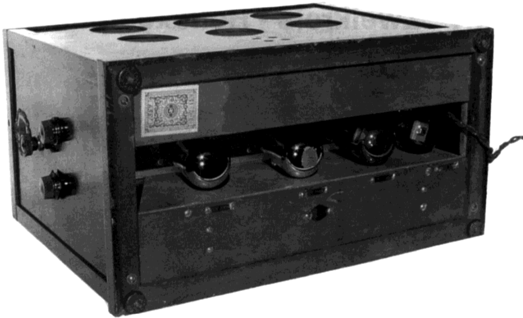
Bild 2: Der "Lautsprecher" von unten. Man erkennt vier hängend eingebaute Röhren.
